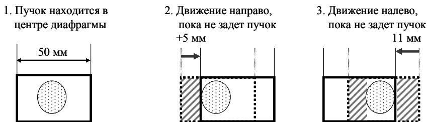
Рис. 6. Принцип измерения профиля пучка COSY
